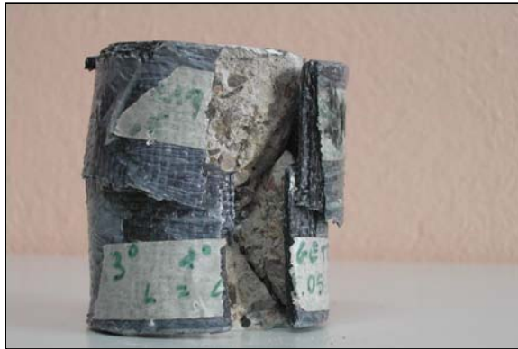
Fig. 5. Tipica superficie di rottura per scorrimento manifestatasi nel conglomerato.
