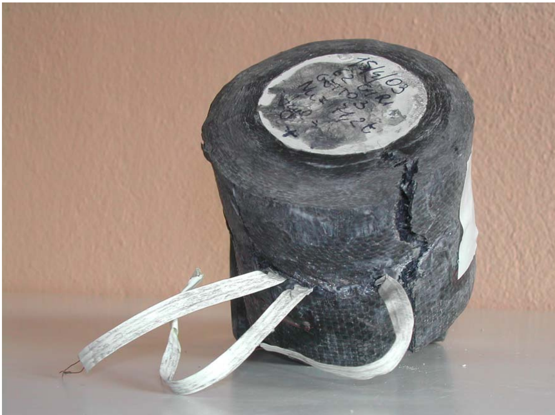
Fig. 5 A e B ( sopra e sotto). Rottura di un provino con 62 giri di avvolgimento. Si notano i fili di connessione degli estensimetri interni all'avvolgimento.
