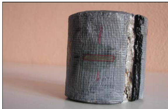
Fig.4 Modalità di rottura di elemento confinato.
